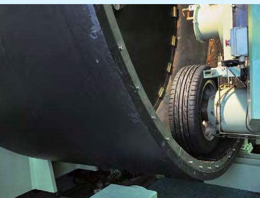
インサイドドラム試験機 ドライ、ウエット、氷路でのタイヤコーナリング特性を測定する装置。
