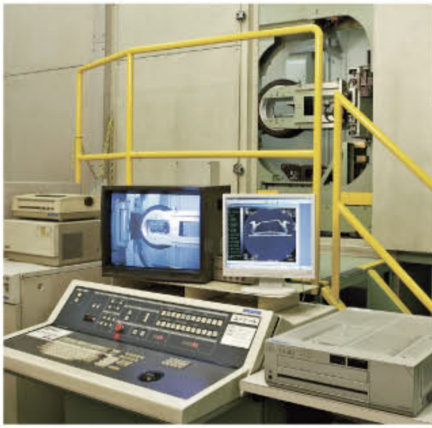
タイヤの内部構造を解析する「X線CTスキャナー」
