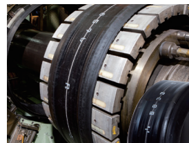
●成形されたタイヤ Assembled Raw Cover
