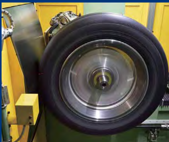
タイヤ転がり抵抗試験機 タイヤの転がり抵抗性能を測定する装置
