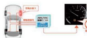
タイヤの回転により発生する車輪速信号を解析することでタイヤの空気圧低下を検知し、ドライバーに知らせるソフトウェアです。
